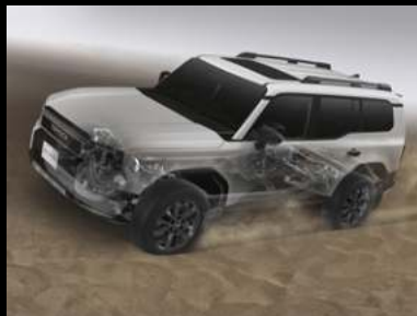
クロールコントロールシステム作動イメージ(スタック状態からの後退脱出)
