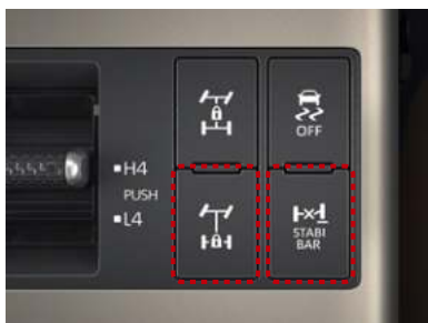
左:電動リヤデフロックスイッチ 右:STABI BARスイッチ
